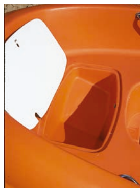
Puits à mouillage / Anchor locker
