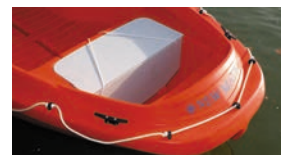
Puits à mouillage Anchor locker
