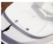
Puits à mouillage Anchor locker
