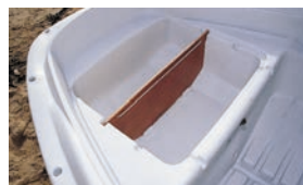
Puits à mouillage / Anchor locker
